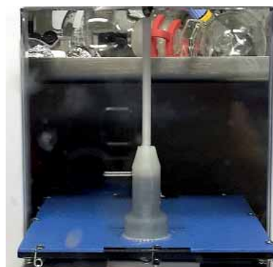
Abb. 1. Foto einer nahezu fertig gestellten NMR-Messröhrchen/Spinner Kombination (der untere Teil wurde mit der Reaktionslösung befüllt).
